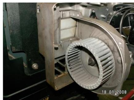
Figure 20. : Brûleur avec clapet d'économie mécanique
