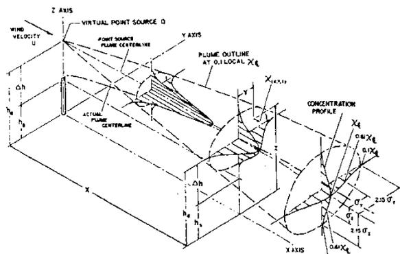
des concentrations par une équation algébrique dans laquelle on tient compte des phénomènes physique de diffusion et de transport par l'intermédiaire de coefficients liées à la distance
